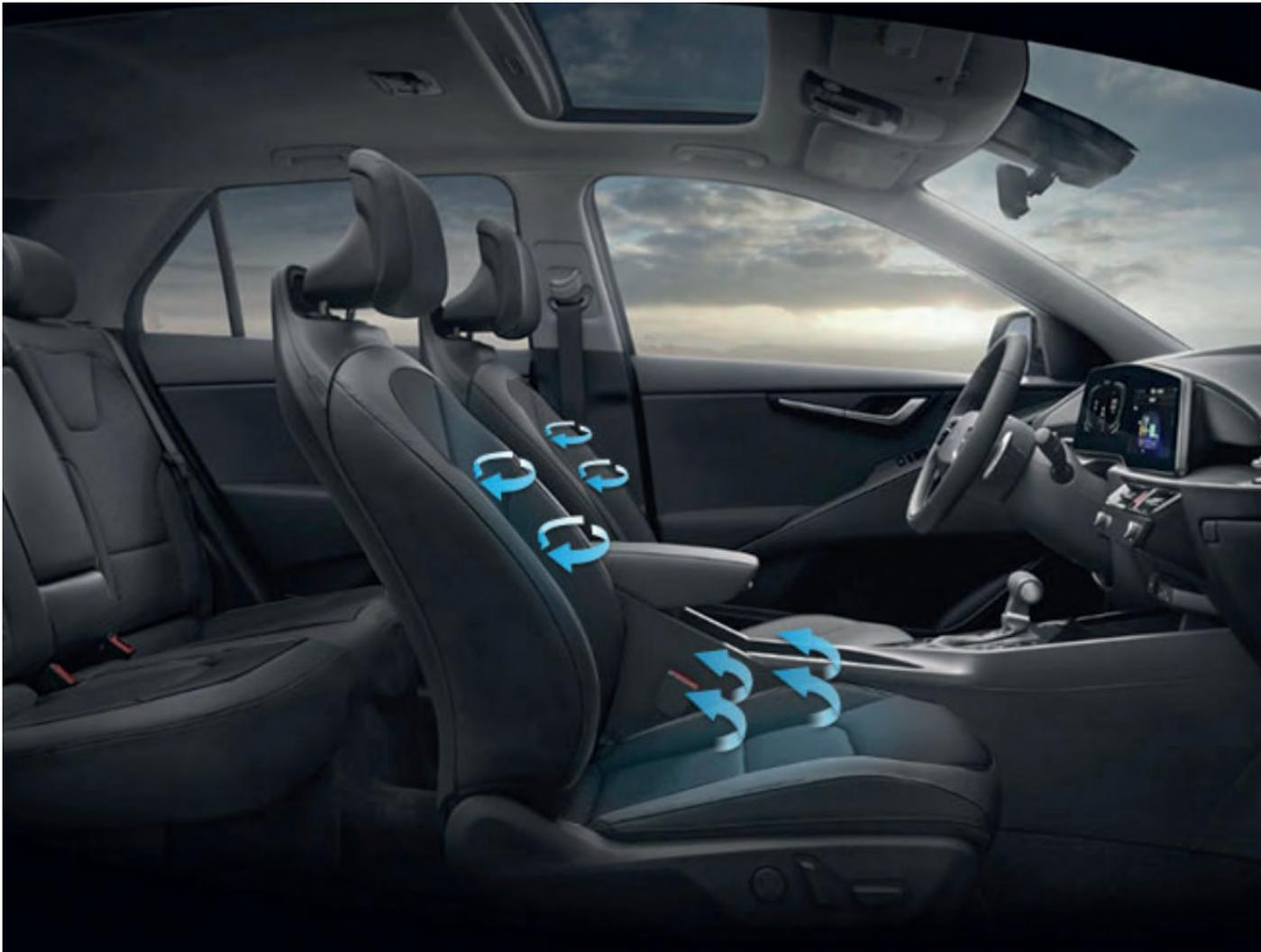
Les sièges avant chauffants de série sont également disponibles en option avec le refroidissement par air et la mémorisation des réglages
