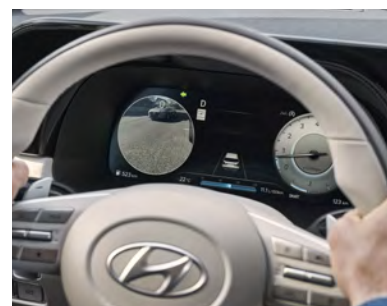
Panneau d'instrumentation entièrement numérique de 12,3 pouces avec moniteur d'angles morts livrables
