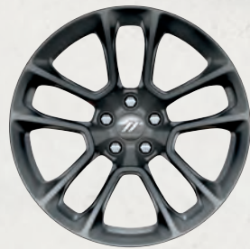
Roues de 20 po en aluminium cristal granit à faible brillance De série sur le modèle Scat Pack 392; livrables en option sur le modèle R/T avec l'ensemble Édition Daytona WRP
