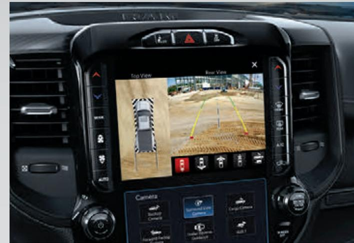
**SYSTÈME DE CAMÉRA PANORAMIQUE SUR 360°<sup>4</sup>**. Des caméras placées stratégiquement à l’intérieur de la calandre, dans les rétroviseurs extérieurs et dans la poignée du hayon permettent au conducteur de voir une image entière des environs du véhicule. Il en résulte des manœuvres de stationnement, de chargement, de déchargement et d’attelage de la remorque plus sûres. Livrable en option.
