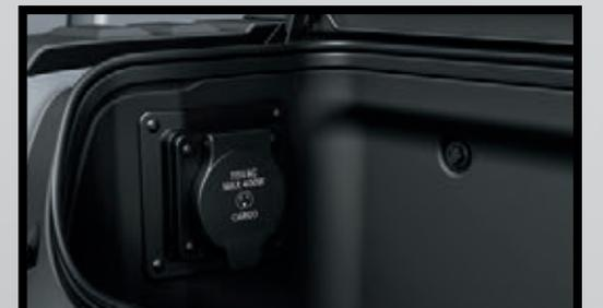
**PRISE DE COURANT DE 115 V, 400 W.** Que ce soit pour le travail ou les loisirs, on a toujours besoin de plus de puissance. C'est la raison pour laquelle une prise de courant de 115 V, 400 W est située sur la paroi intérieure du bac côté conducteur du système RamBox.
