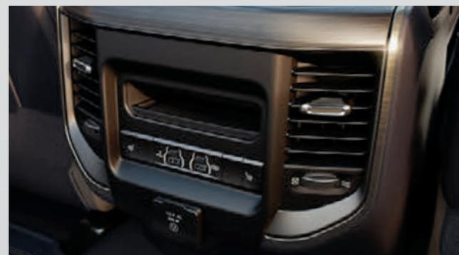
**CONNECTIVITÉ POUR TOUS.** Les passagers arrière bénéficient également de nombreux équipements, avec deux ports USB livrables en option (paires Type-A/C avec les sièges baquets; deux ports USB Type-A avec les banquettes; recharge uniquement dans les deux configurations) et une prise 115 V, 400 W livrable en option, commodément située à l'arrière de la console centrale. Le double porte-gobelet offre également la possibilité de loger une tablette au bénéfice des passagers arrière.
