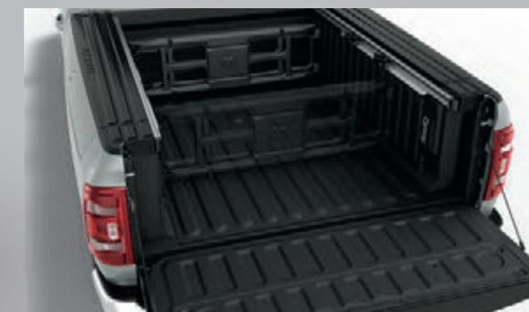
**GÉREZ VOTRE RANGEMENT** Pour une organisation du chargement supplémentaire, choisissez l'ensemble de commodités RamBox<sup>MD</sup> qui comprend un diviseur de caisse et un système de rails intégrés de caisse de chargement avec quatre boucles d'arrimage réglables.
