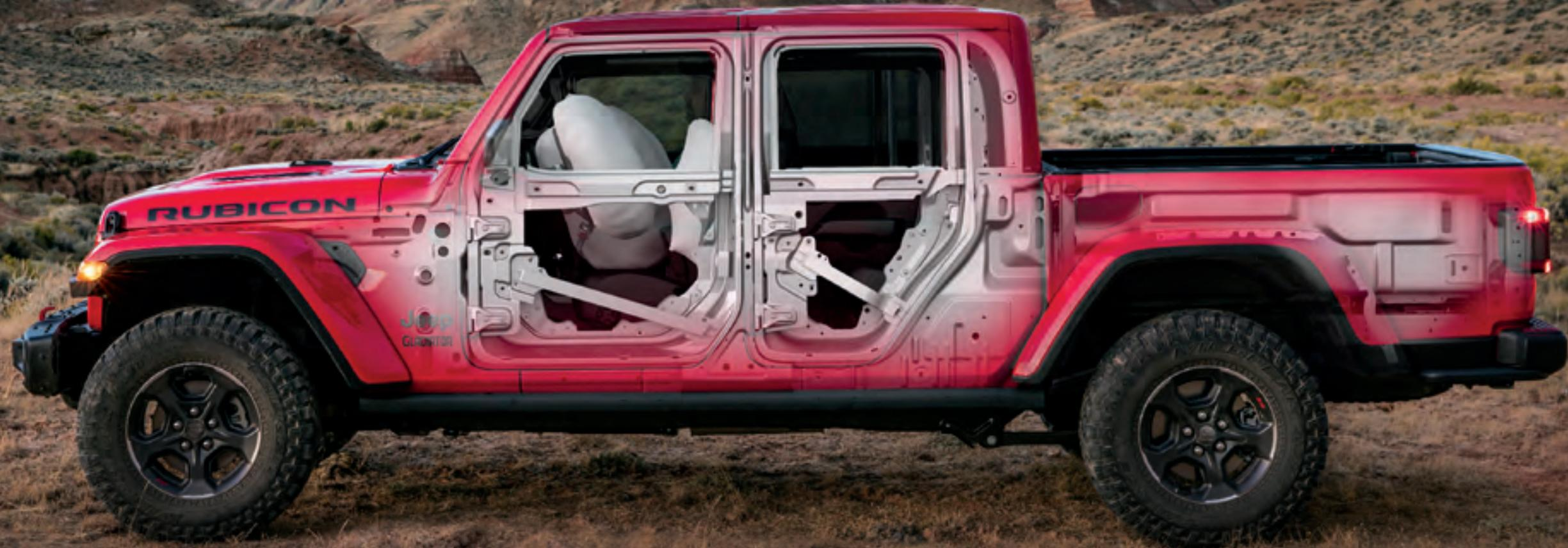
**CARROSSERIE SOLIDE** La cage de sécurité exceptionnellement solide est constituée d'acier à haute résistance couplé à de l'aluminium léger, afin de rendre le Jeep® Gladiator plus léger, mais muni d'un châssis très résistant. De série.
