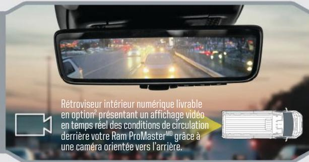
Rétroviseur intérieur numérique livrable en option<sup>2</sup> présentant un affichage vidéo en temps réel des conditions de circulation derrière votre Ram ProMaster<sup>MD</sup> grâce à une caméra orientée vers l'arrière.
